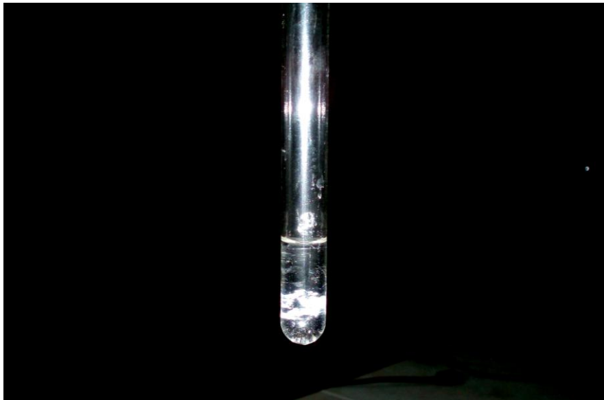
Figura 4 - 4. Termosifón de vidrio. Largo=80cm, diámetro=10mm. Se observa cómo se genera la evaporación del volumen de agua.
