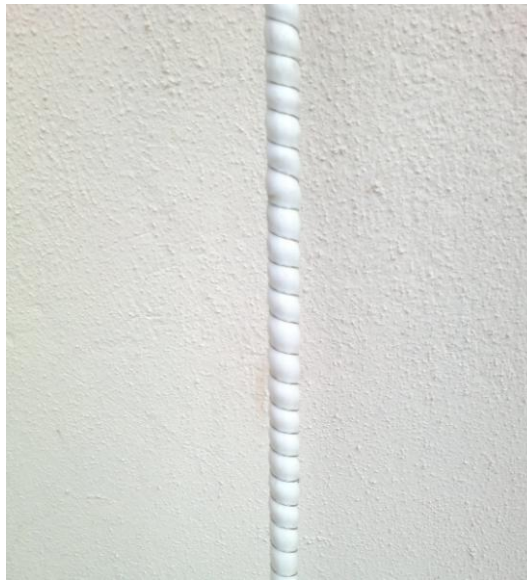
Figura 6 - 2. Embobinado de los tubos construidos. Se observa el recubrimiento con la funda de material sintético (color blanco) y el conductor de kanthal.
