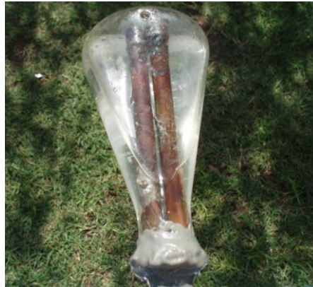
Figura 8 - 6. Contenedor con dos tubos de calor construidos. Se observa el agujero donde se introduce el agua.
