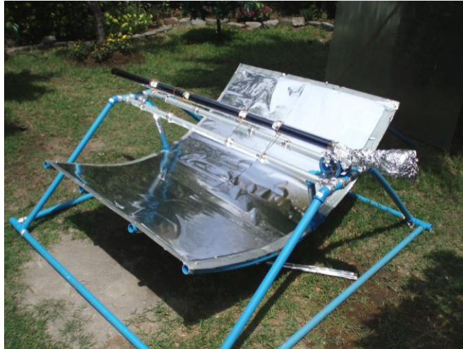
Figura 4 - 9. Concentrador solar N°2 construido. Estructura del concentrador solar y en su foco un tubo de calor dentro de tubo de doble pared de vidrio al vacío.
