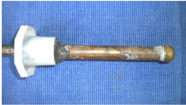
Figura 4 - 2. Termosifón construido. Se observa en la imagen el resultado final de la construcción del tubo.
