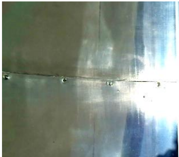
Figura 4 -7. Planchas lijadas y unidas. Se observa en la imagen la unión de dos planchas de latón ya pulidas, por medio de remaches.
