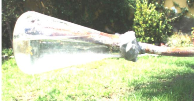
Figura 8 - 2. Resultado modificación de condensador. La imagen muestra la curvatura del tubo, el contenedor de agua y el sello epóxico utilizado para filtraciones.
