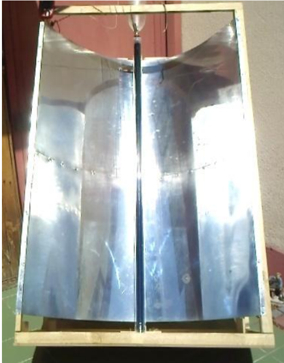
Figura 4 - 8. Concentrador solar N°1 construido. Estructura del concentrador solar y en el foco el tubo al vacío de doble pared.
