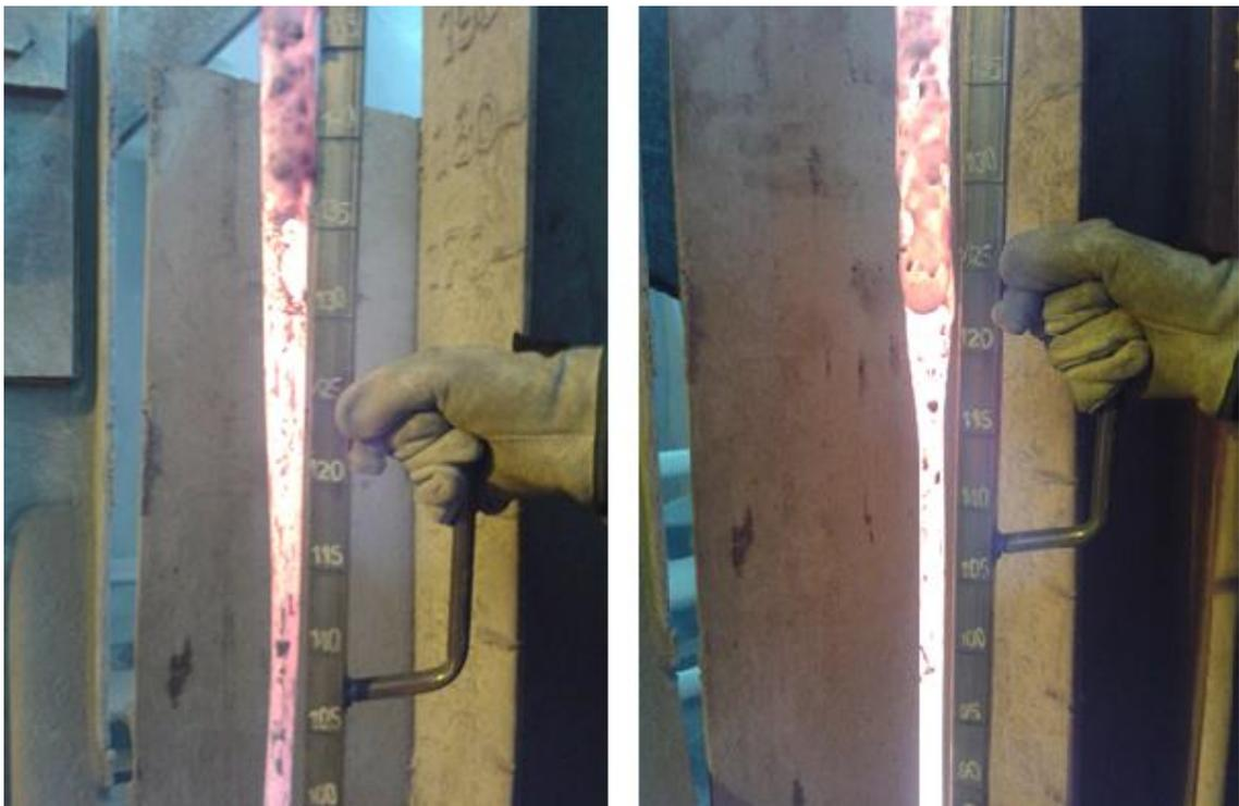
**Figura 17.** Operario observando nivel de MB por el método de la barra corroída.
