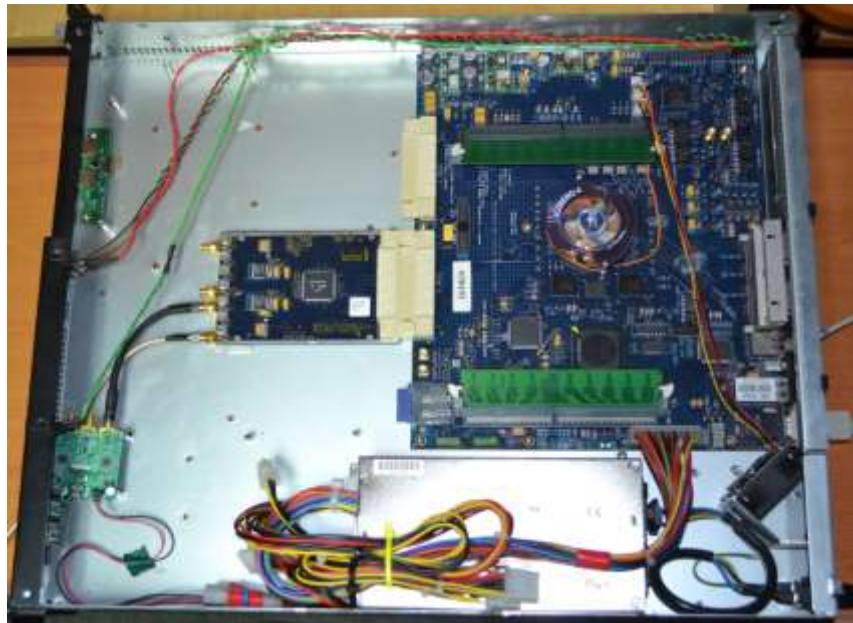
Figura 2.9: ROACH es una placa de procesamiento independiente FPGA. Se puede observar la Virtex 5 FPGA, la tarjeta ADC y los diferentes conectores.
