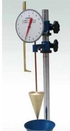
**Figura 2.2** Penetrómetro de cono para medición de límite líquido.
