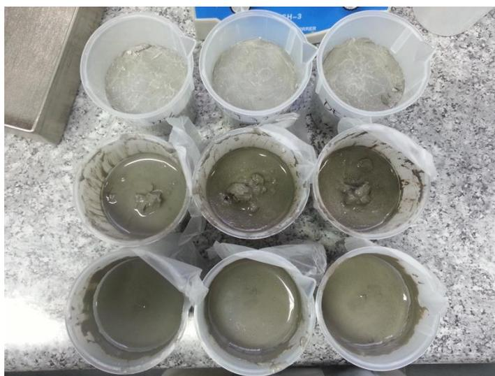
**Figura 9.9** Muestras de CPB con diferentes consistencias luego de 48 horas.
