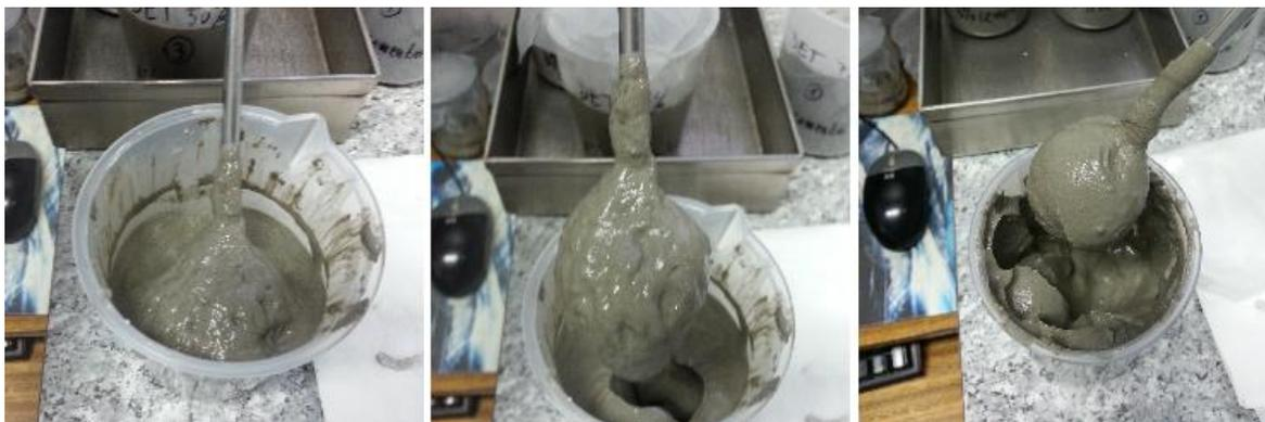
**Figura 9.10** Consistencia de CPB con 50% de concentración de sólidos, luego de 18 horas.
