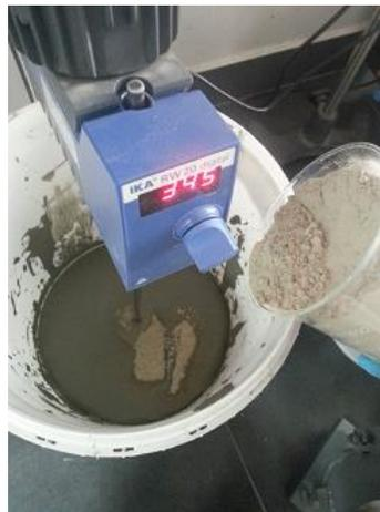
**Figura 3.2** Proceso de homogeneización de pulpa y cemento.
