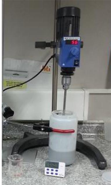
**Figura 3.1** Homogenización de pulpa con agitador mecánico.
