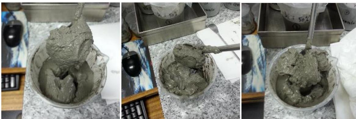
**Figura 9.11** Consistencia de CPB con 60% de concentración de sólidos, luego de 18 horas.
