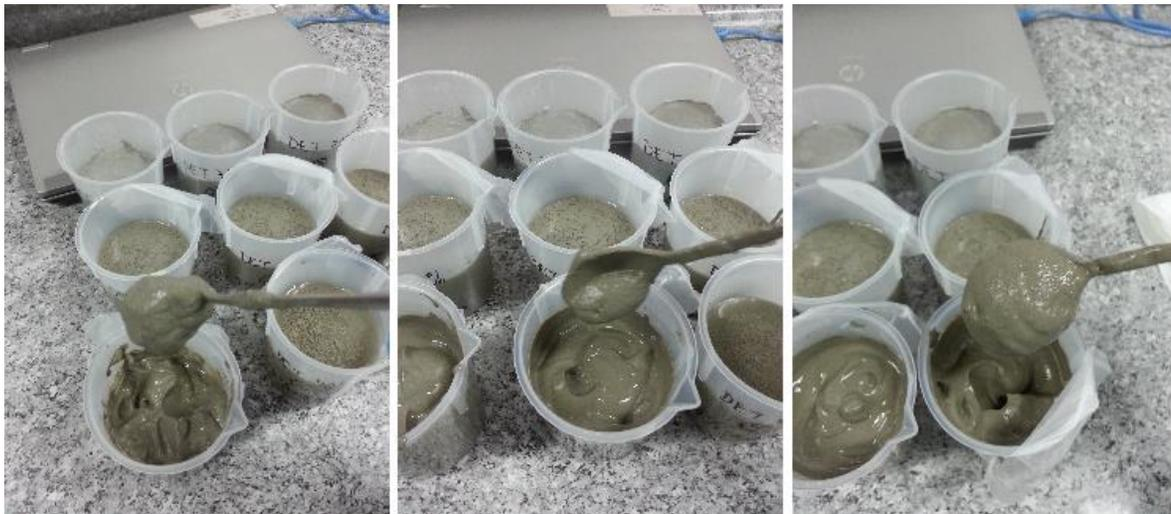
**Figura 9.7** Consistencia de CPB con 50% de concentración de sólidos, luego de 18 horas.
