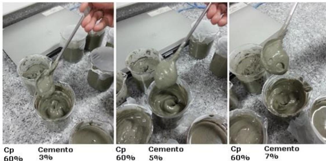
**Figura 9.4** Consistencia de CPB con 60% de concentración de sólidos, luego de 3 horas
