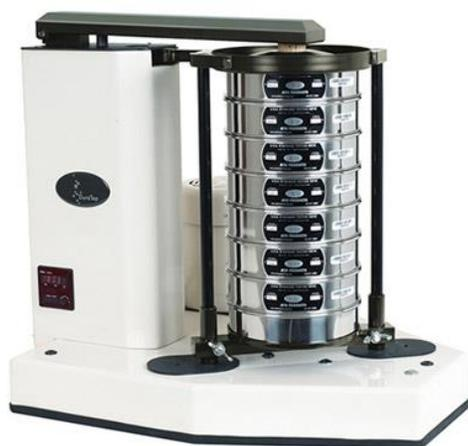
**Figura 2.5** Vibrador de tamices RO-TAP (CI-JRI).
