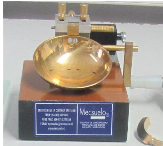
Figura 2.3 Equipo Casagrande para límite plástico. Imagen propia.
