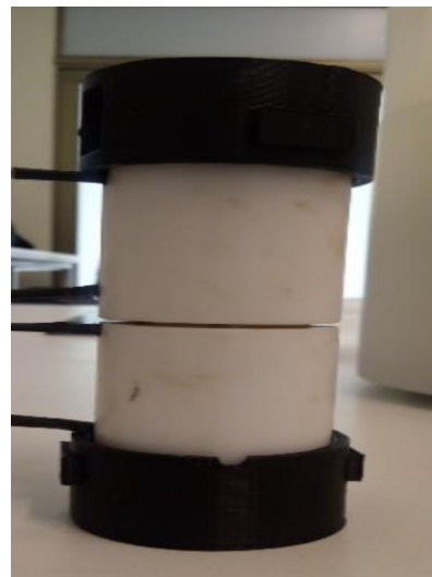
Figura 10. (a) Estructura principal del dispositivo sin recubrimiento aislante. (b) Módulo con armazón aislante y termopares instalados.
