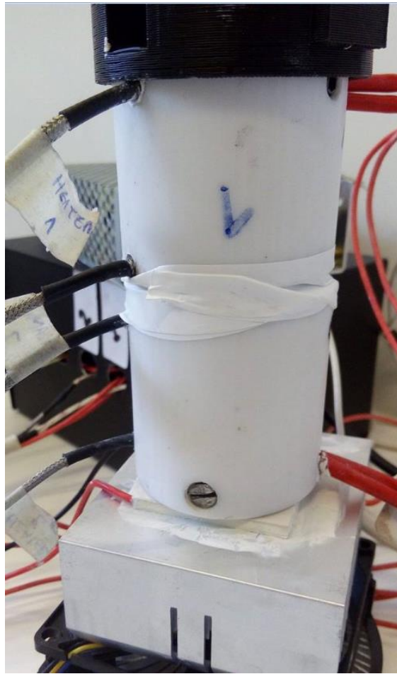
Figura 19. Montaje Experimental con celda Peltier incorporado.
