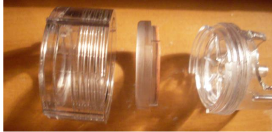
Figura N°12: Soporte del filtro original usado en el equipo Simca. Módulo del filtro
