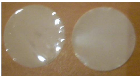
Figura N°8: Filtro Nuclepore por su lado brillante (izquierda) y opaco (derecha).
