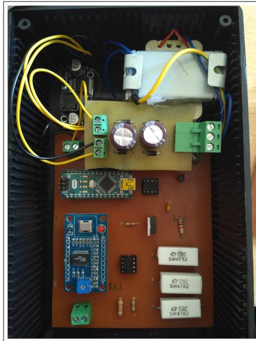
Figura 4.11: Fotografía del circuito de un LED emisor.
