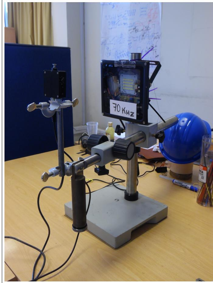
Figura 4.19: Montaje experimental realizado para la medición de la potencia lumínica en función del ángulo  $\phi$ .
