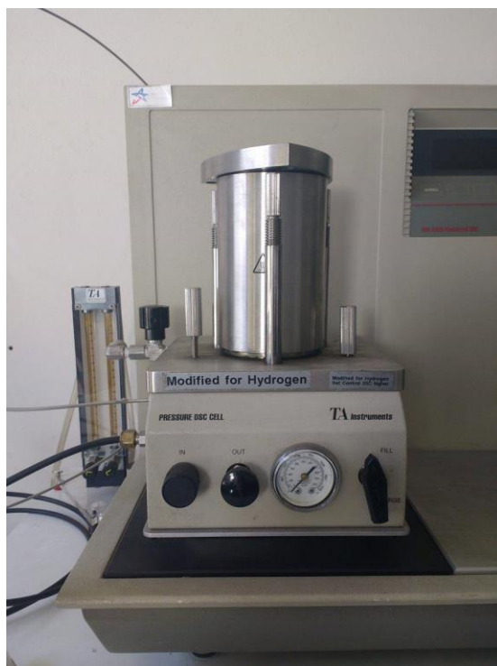
Figura 2.4: Equipo de CDB (Modified for Hydrogen) Pressure DSC cell TA Instruments, en el cual se deposita la muestra y la referencia.
