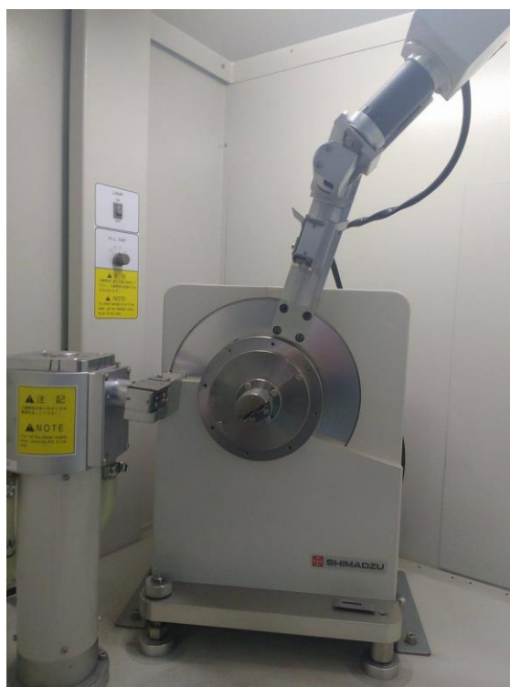
Figura 2.3: Difractómetro de rayos X Shimadzu XRD-6000.
