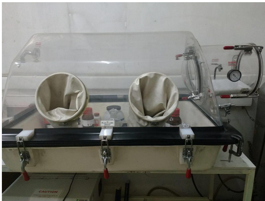
Figura 2.1: Cámara de guantes Nitrogen Dry Box 850-NB, atmósfera controlada en gas inerte.
