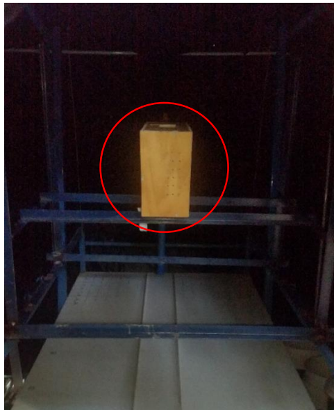
Figura 3.4 Caja de madera que contiene al proyector y la cámara. Ésta contiene ranuras para poder manipular los botones de ambos dispositivos.
