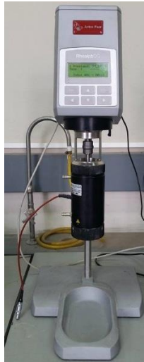
Figura 3.7 Reómetro utilizado para la medición de las propiedades del fluido no newtoniano presente en el laboratorio de pirometalurgia del Departamento de Ingeniería en Minas de la Facultad de Ciencias Físicas y Matemáticas de la Universidad de Chile.
