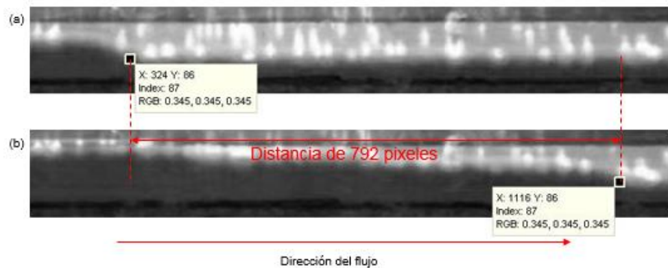
Figura 4.10 Captura lateral para caudal 171,7 \pm 1,9 \text{ cm}^3/\text{s} a una concentración del 11% (a) Obtención de coordenadas cuando la onda entra al campo de la cámara y (b) coordenadas cuando la onda sale del campo de la cámara.
