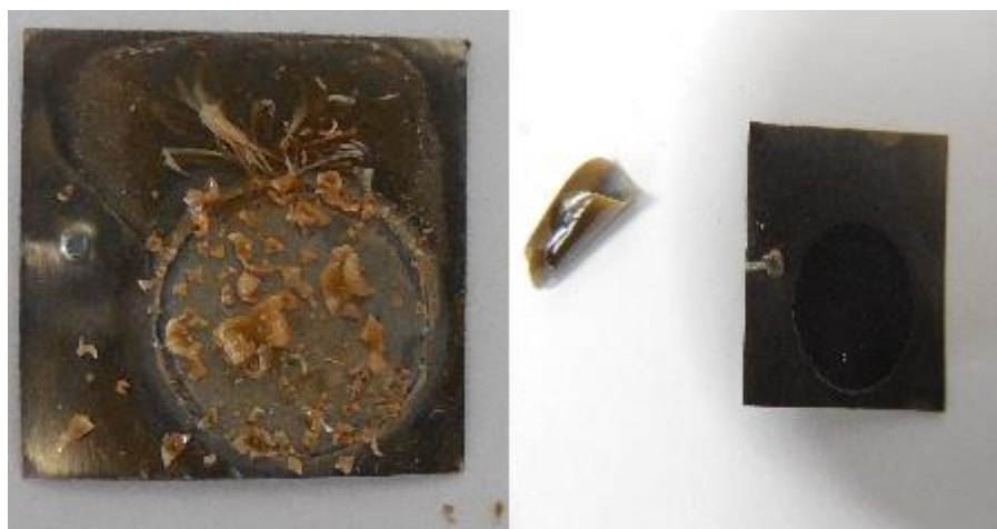
Figura 3.8: TiO 2 desprendido de su placa inicial, 60[V], 45 min de anodizado inverso, 20 horas normal.
