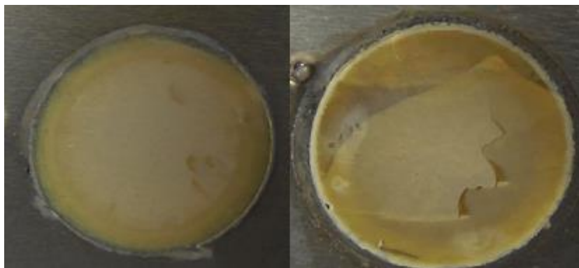
Figura 3.9: (Izquierda) 40[V], 1 hr anodizado inverso, 20 horas anodizado normal. (Derecha) 50V, 1 [hr] anodizado inverso, 20 [hr] anodizado normal.
