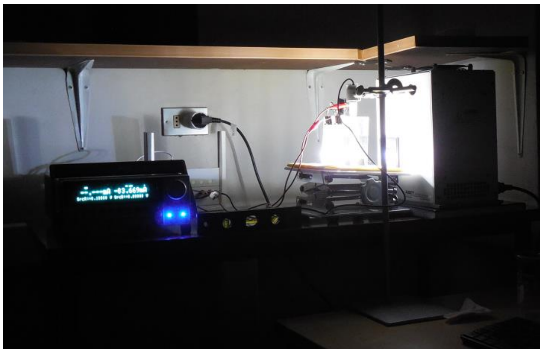
Figura 2.4: Montaje foto-electroquímico real montado en oscuridad, los tres electrodos van hacia el equipo Keithley y se ilumina la muestra ocupando simulador solar ABET.
