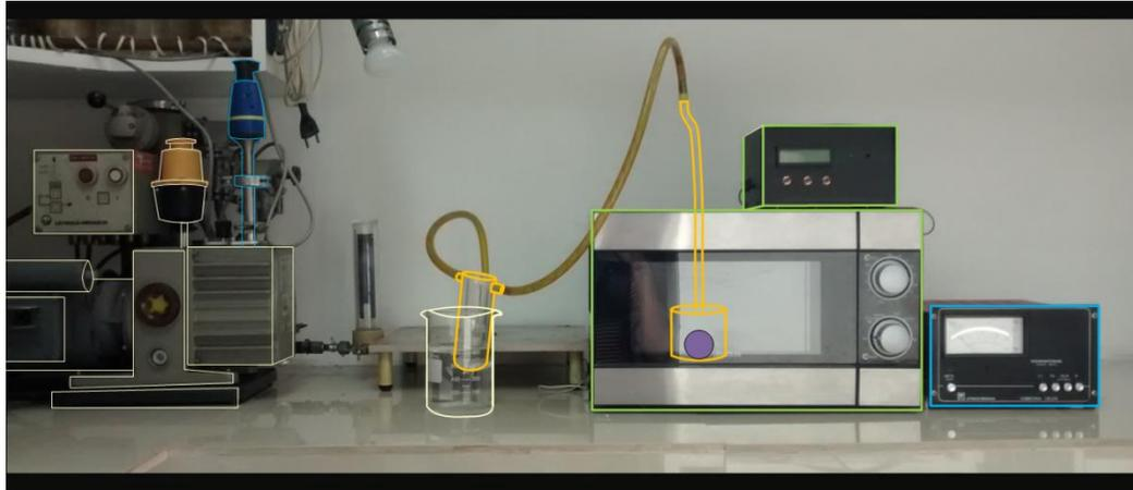
**Figura 3.7:** Imagen del montaje experimental para el sistema de secado asistido por microondas y vacío.
