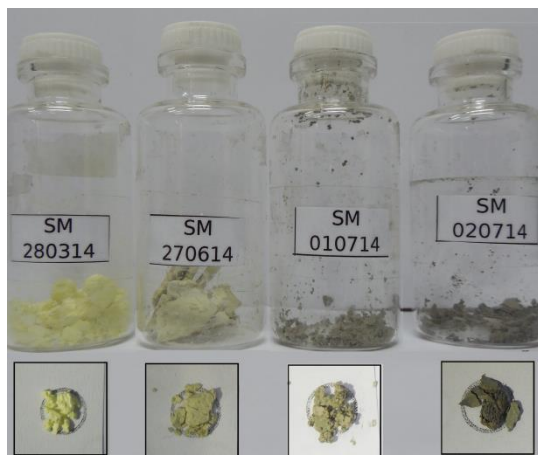
Figura 3.6.2: Resultado final de la síntesis del set de muestras 3.6.
