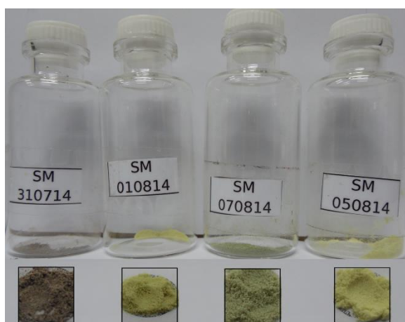
Figura 3.3.2: Resultado final de la síntesis del set de muestras 3.3.
