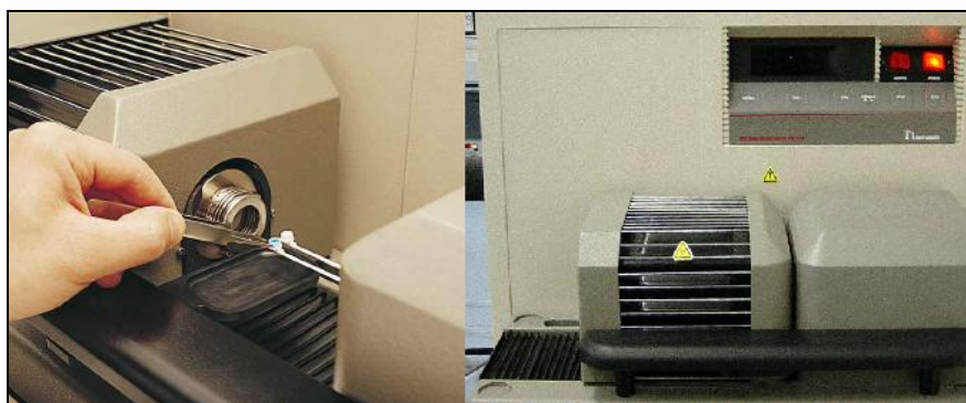
Figura 3.1.- Termobalanza TA Instruments SDT 2960 con DSC-TGA simultáneos utilizada en este experimento.
