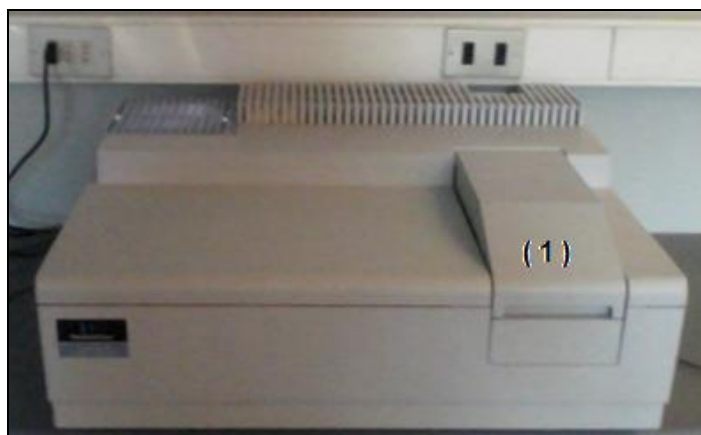
Figura 3.4.- Espectrómetro UV/VIS Perkin Elmer. (1) Lugar de instalación de los accesorios portátiles.
