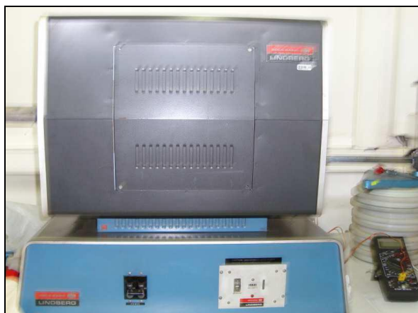
Figura 3.2.- Horno Lindberg utilizado para tratar térmicamente la fase Bi_2YNbO_7 .
