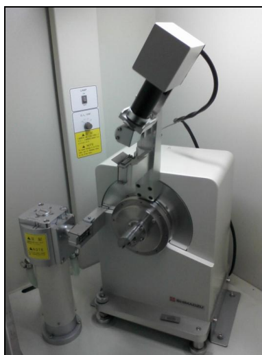
Figura 3.3.- Difractómetro de rayos x Shimadzu XRD 6000 con ánodo de cobre y geometría de Bragg-Brentano.
