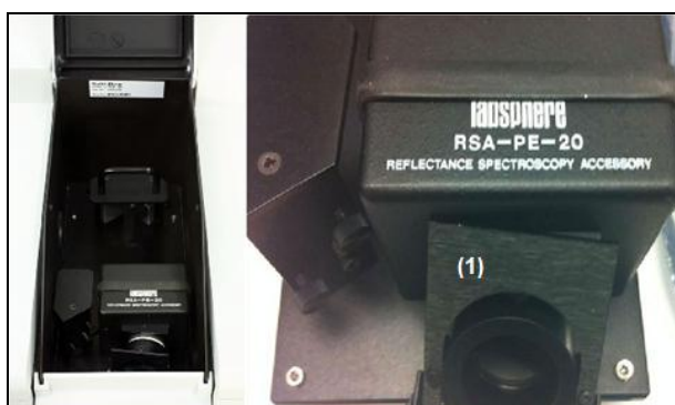
Figura 3.5.- Accesorio de reflectancia difusa RSA-PE-20 instalada en espectrómetro UV/VIS.
