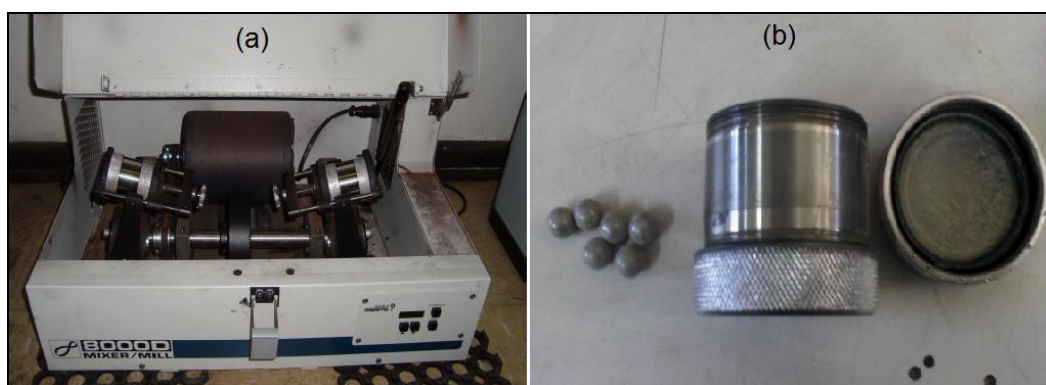
Figura 1.10.- Molino Spex 8000D con sus respectivos contenedores (a) y las bolillas de acero endurecido con los respectivos contenedores WC (b).
