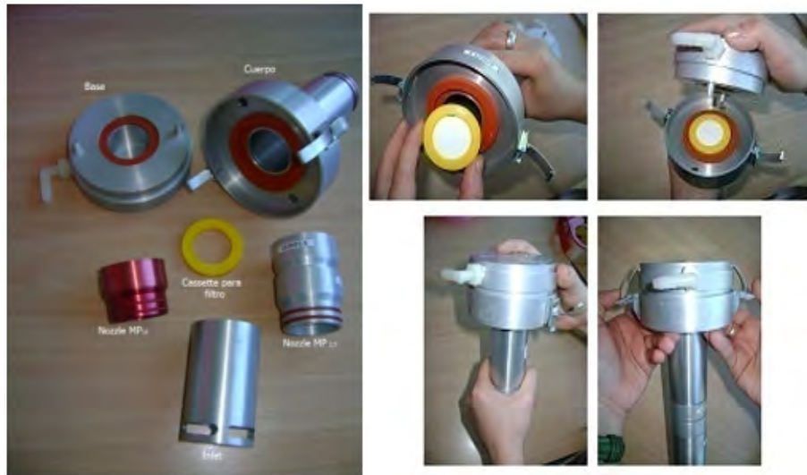
Figura 2.2. Cabezales del HI separados por partes, se observa que en medio de este se ubica el filtro colector de color blanco. Fuente: CMMCH
