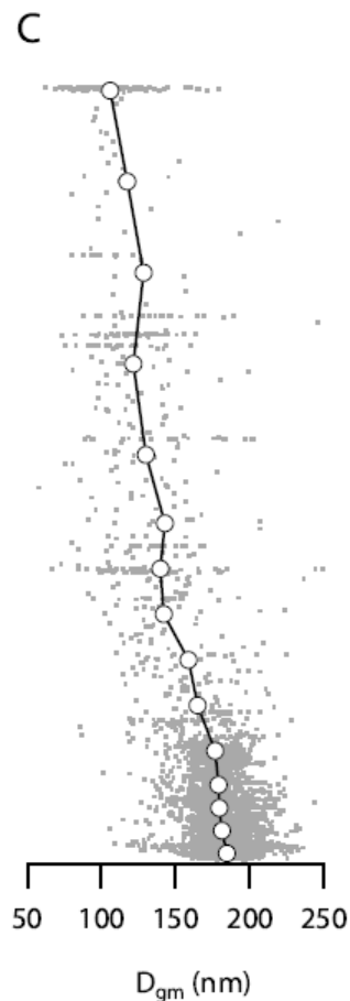
Figura 6-8 Diámetro promedio de masa de carbono negro para todos los vuelos. Los puntos puntos de datos individuales se muestran en gris; los promedios se muestran en círculos negros.
